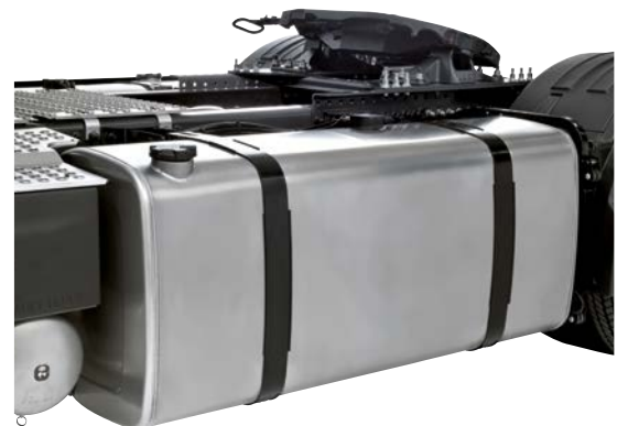
RÉSERVOIRS D'UNE CAPACITÉ TOTALE DE 1420 L pour une autonomie prolongée.
